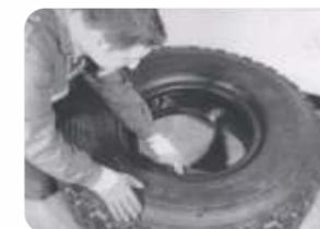
Aplaste la cámara en los laterales del neumático.
