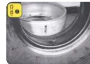
Asegurar la tapa de la válvula, y coloquela en la ranura de la llanta.
