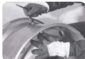
Instale la válvula, limpie las partes metálicas. Asegúrese de instalar la válvula correctamente.
