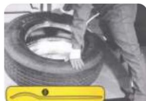
Instale un lateral del talón en la parte cóncava de la llanta, contraria a la válvula. Presione el talón y haga que este encaje dentro de la llanta. Entonces utilice su rodilla para presionar entre el neumáticos y el anillo de borde. Si tiene dificultades puede utilizar una palanca.
