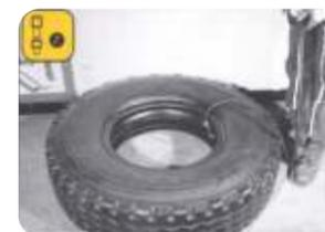
Remover la válvula. Presione la cámara para remover el aire entre el neumático, luego asegurar la válvula con su protector.
