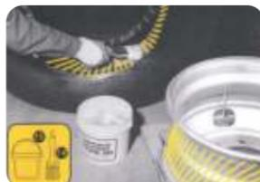
Lubrique el interior del neumático y la llanta.
