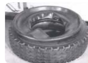
Coloque la cámara encima del neumático, la válvula debe quedar en el lado superior.
